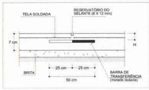
2 DETALHE JUNTAS SERRADAS (JS) S/ ESCALA
